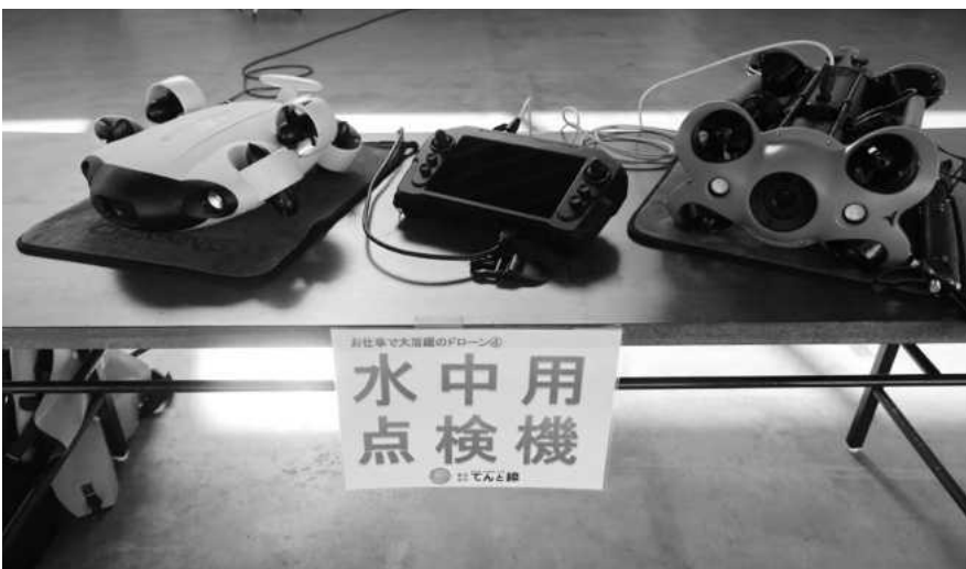
ドローン水中用点検機 (展示)
